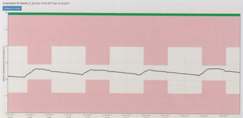
Bild 4: Das Gebäude kann als Wärmespeicher genutzt werden, in dem innerhalb der zulässigen Bandbreite des gewünschten Klimaprofils – hier in den Kernzeiten zwischen 20 und 24,5 °C – bewusst überheizt oder unterkühlt wird.
